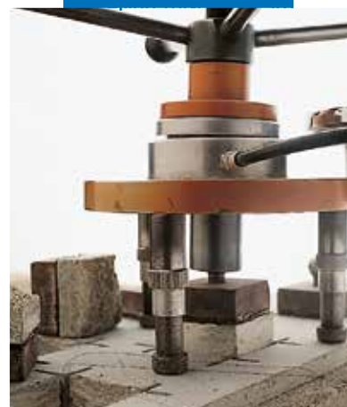
Испытание на адгезию SATTEC
